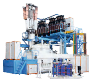
ДВА-200ДМ Вакуумная электродуговая плавильная печь для расплавления сплавов из титана и последующей разливки в литейные формы Получение слитков от 160 до 400 кг
